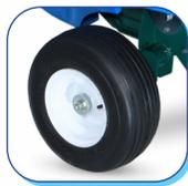
**6 PLY TUBELESS WHEELS** HELPS IN MAINTAINING THE SAME LINE AS REEL TINE & ENSURES ACCURATE PICKUP
