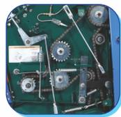
**HIGH QUALITY CHAINS & BEARINGS WITH AUTO LUBRICATING SYSTEM** HELPS IN BETTER OPERATION
