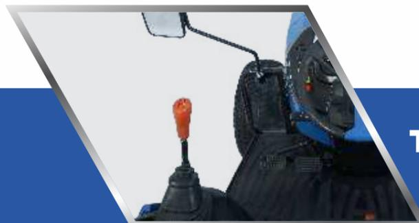
Solis H38 è stato progettato per la massima efficienza e manovrabilità. La trasmissione HST a 3 rapporti assicura un cambio marcia fluido, mentre il blocco differenziale meccanico ottimizza la trazione su terreni scivolosi o irregolari. Grazie a un assale anteriore 4x4 a portale e il cambio laterale, garantisce prestazioni ottimali per tutte le attività agricole.
