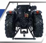
Il sistema idraulico di questo trattore è costruito per operazioni pesanti. Dotato di attacco a tre punti GAT II e un'impressionante capacità di 2500 kg, garantisce fluidità, controllo preciso e consente di affrontare qualsiasi lavoro con facilità, un'elevata portata di 45 LPM combinata con un'efficienza della pompa idraulica del 90% garantisce un controllo fluido e preciso.
